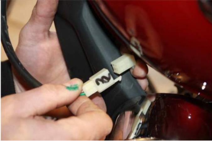
3.6.4. Подключаем разъем датчика уровня топлива.
