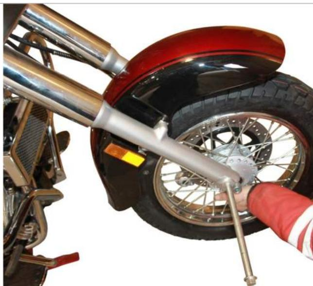
3.18.5. Установите колесо. Наполовину вставьте осевой болт с левой стороны мотоцикла.
