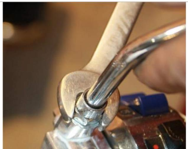
3.19.2. Зафиксируйте гайку ключом. Зеркало установлено. С другой стороны мотоцикла зеркало устанавливается аналогично.
