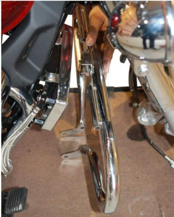
3.16.1. Устанавливаем защитную дугу так, как указано на рисунке.
