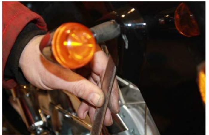
3.7.2. Выравниваем указатель поворотов. Закручиваем гайку.
