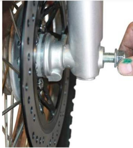
3.18.8. Закрутите фиксирующую гайку с левой стороны мотоцикла.
