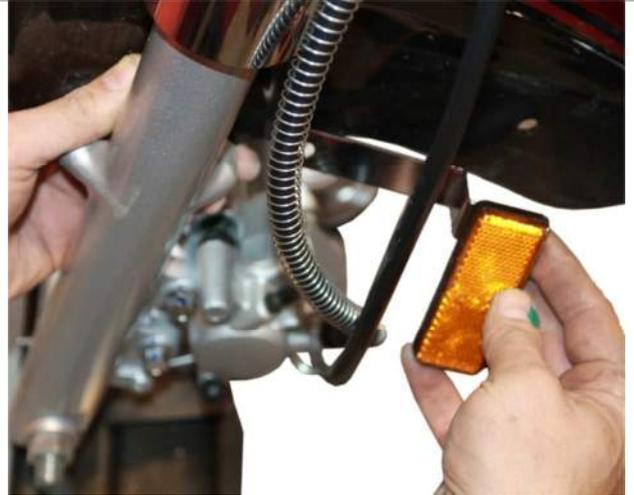
3.17.5. Установите кронштейн крепления катафота между амортизатором и крылом так, как указано на рисунке.
