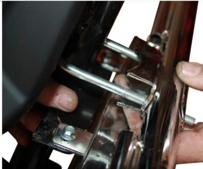
3.16.2. В верхней части рымы мотоцикла защитную дугу крепим с помощью хомута из комплекта поставки.
