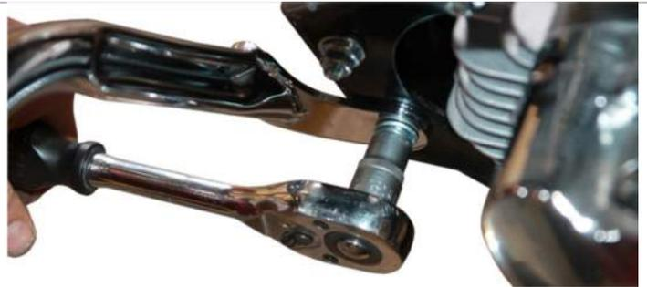
3.16.9. Выравниваем защитную дугу. Протягиваем все резьбовые соединения в местах ее крепления.
