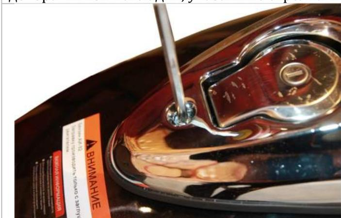
3.6.3. Закручиваем ранее выкрученные винты.
