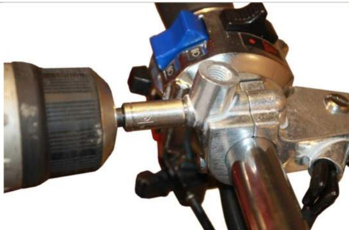
3.4.3. Фиксируем хомут болтами из комплекта крепежа.
