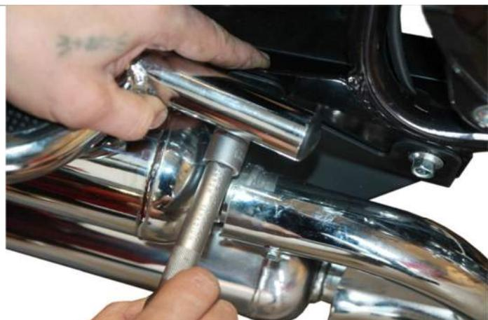
3.10.5. Фиксируем ее с левой и правой сторон мотоцикла в точке соединения ее с задним багажником.
