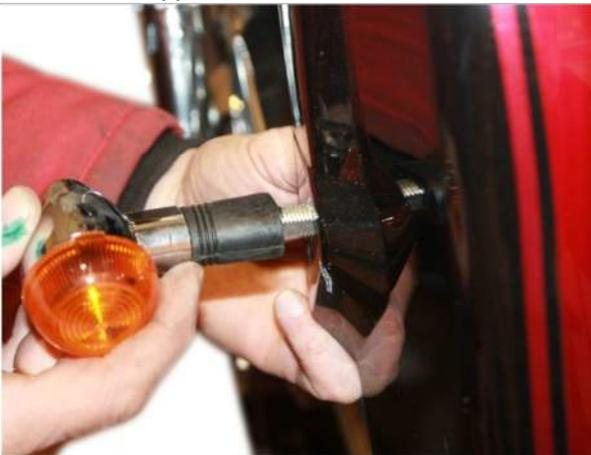
3.7.1. Устанавливаем указатель поворотов. Фиксируем его гайкой.
