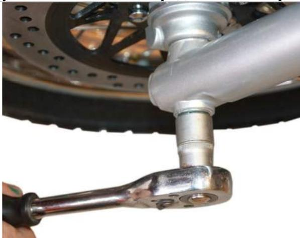
3.18.9. Затяните ключом фиксирующую гайку.
