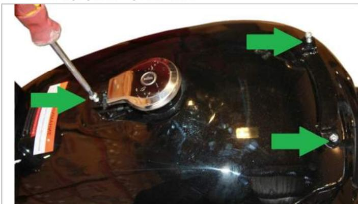
3.6.1. Откручиваем три винта крепления декоративной накладки, указанные стрелками.
