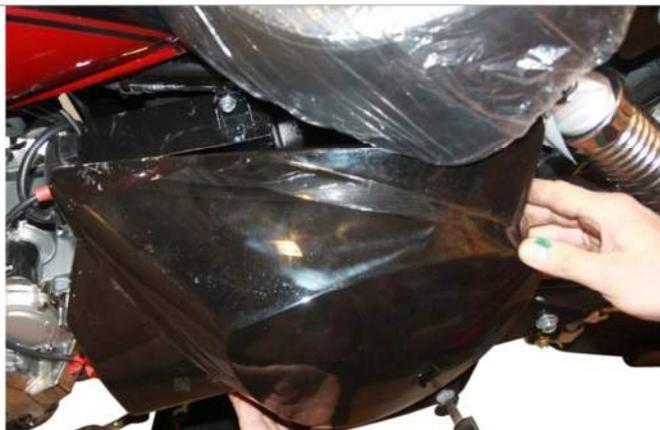
3.5.1. Для установки АКБ необходимо снять боковой пластик мотоцикла. Для этого ключом открываем замок на боковом пластике. После этого снимаем боковой пластик.
