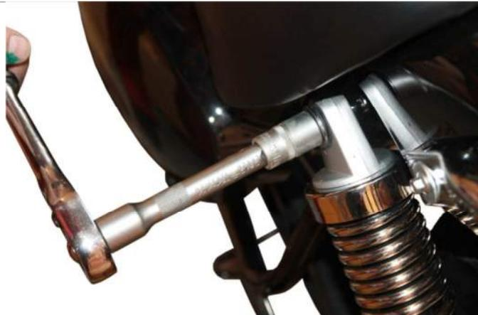
3.9.3. Наживите и затем затяните гайку крепления заднего амортизатора с шайбой.
