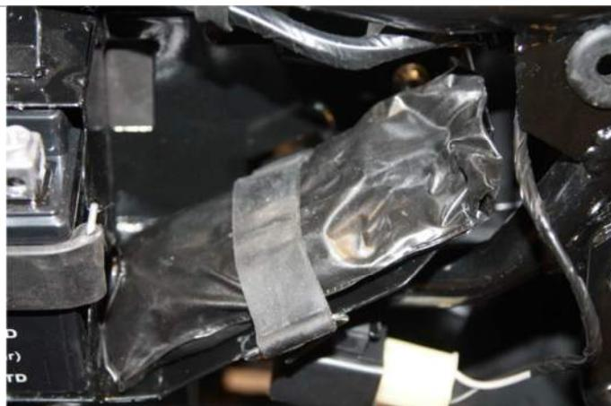
3.5.2. Укладываем в инструментальный ящик комплект ключей. Закрепляем его с помощью фиксатора.
