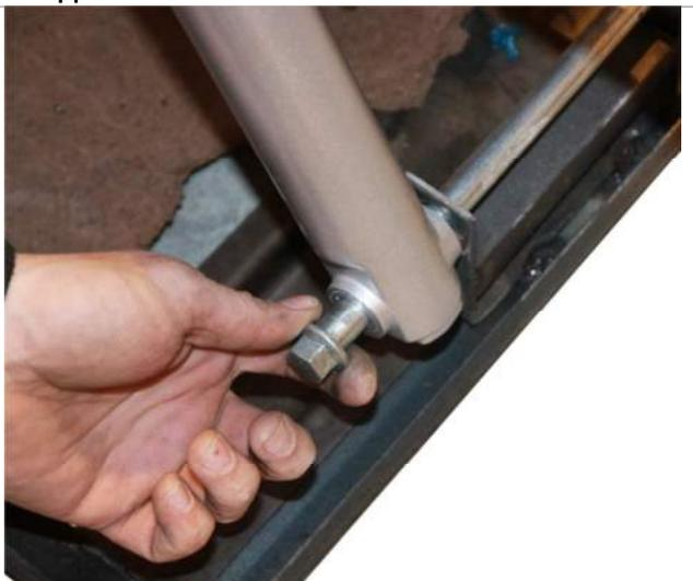
3.18.1. Открутите транспортировочную гайку осевого болта переднего колеса с помощью ключа на 22мм.
