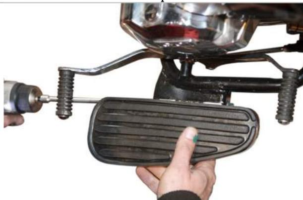
3.13.5. Закручиваем болты крепления подножек водителя.
