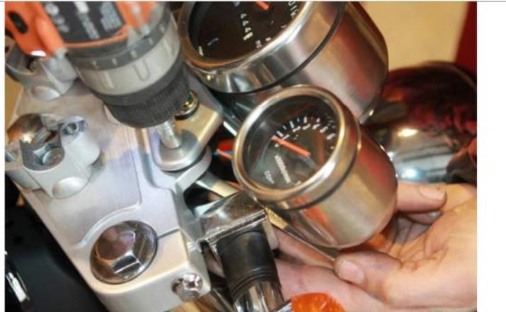
3.1.4. Зафиксируйте приборную панель подготовленными болтом с шайбой и гайкой (две последние устанавливаются снизу приборной панели).
