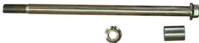
3.18.3. Для установки переднего колеса необходим осевой болт (пункт 3.18.1.), втулка переднего колеса (1 шт.) и гайка М19 (1 шт.) из комплекта поставки.
