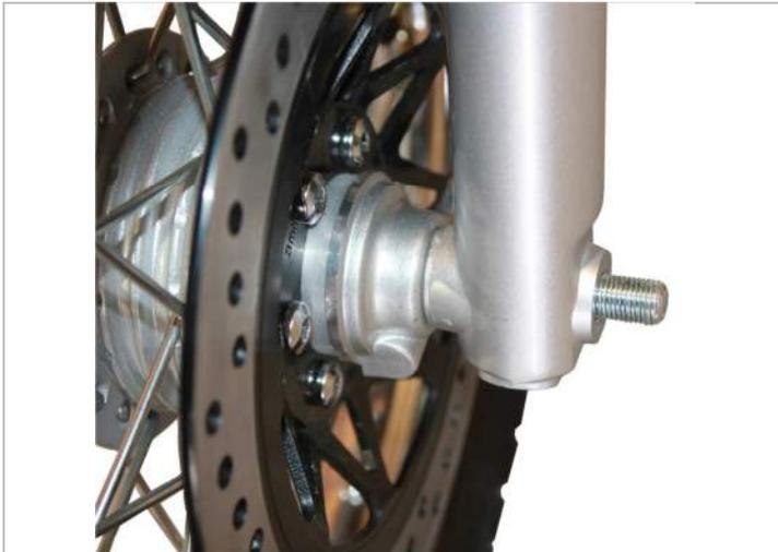
3.18.7. Привода спидометра должен быть установлен так, как представлено на рисунке.
