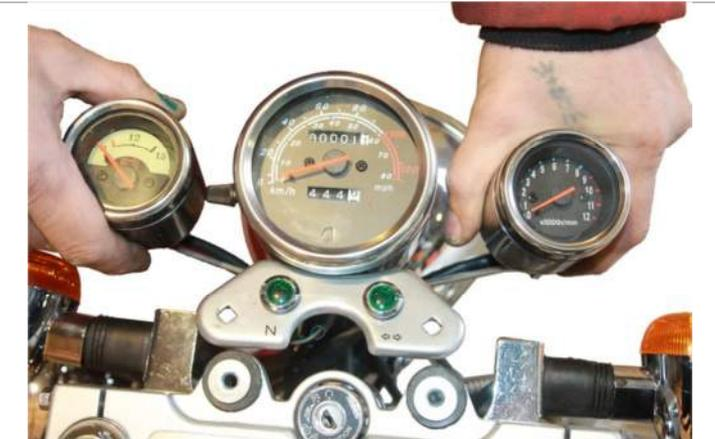
3.1.3. Установите приборную панель в рабочее положение.
