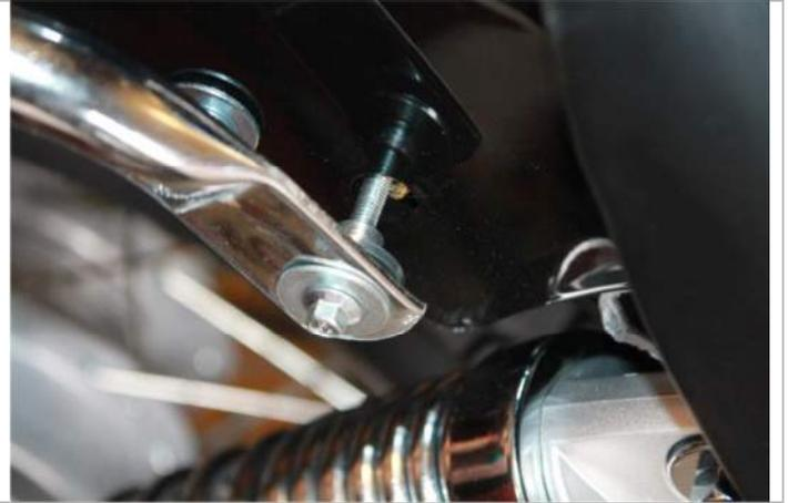
3.8.3. Фиксируем его с помощью ранее выкрученных болтов.
