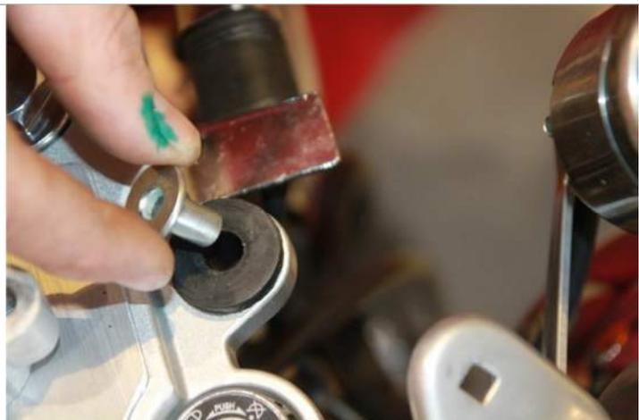
3.1.1. Для установки приборной панели используем болт хромированный М8 (2 шт.), гайку (2 шт.) и шайбу (2 шт.) для данного болта, а также втулку металлическую (2 шт.) идущих в комплекте поставки.
