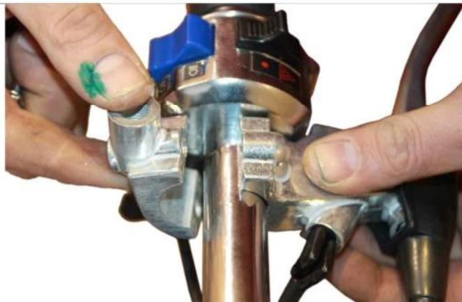
3.4.1. Для его крепления понадобятся короткий и блинный болты М8 (2 шт.), и хомут крепления рычага (1 шт.), идущих в комплекте крепежа.
