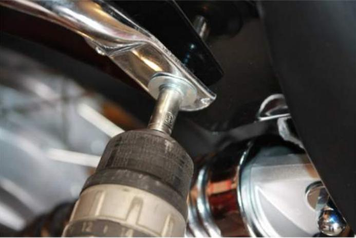
3.8.4. Закручиваем болты, крепящие задний багажник.
