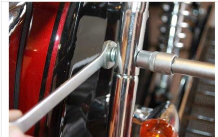
3.10.7. Закручиваем болт с гайкой с левой и правой сторон мотоцикла в точке соединения подножки с задним багажником.
