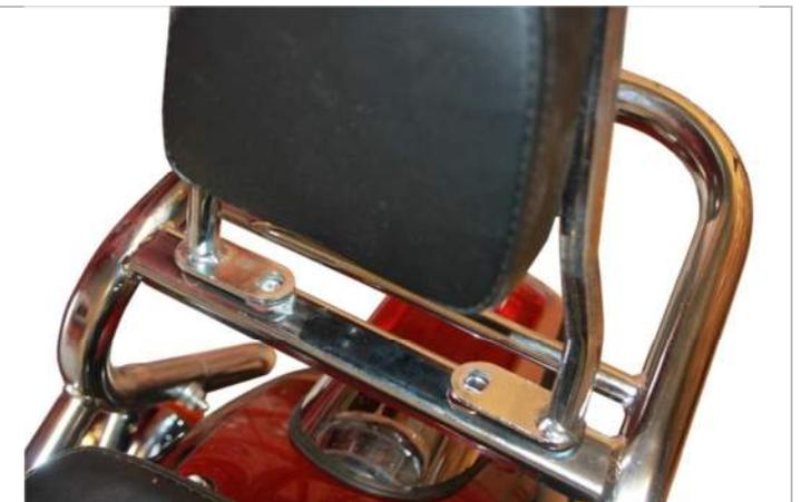
3.12.1. Для установки спинки из комплекта крепежа необходим болт М10 (2 шт.) и гайка под данный болт (2 шт.).
