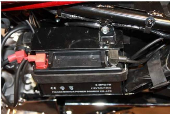
3.5.3. Установите клеммы согласно полярности, где красный это «+», установите клеммы согласно полярности, где красный это «+», черный соответственно «-». **Строго соблюдайте полярность!** Не соединяйте «+» и «-» вместе, это может привести к короткому замыканию и возгоранию мотоцикла, выходу из строя его электрических частей. Аккуратно уложите провода в свободном промежутке между АКБ и кузовом. Зафиксируйте АКБ.
