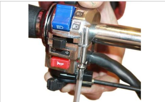
3.3.2. Разводим две половины левого блока переключателей в разные стороны, одеваем на руль и сводим обратно так, как показано на рисунке.
