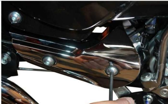
3.14.3. Закручиваем ранее выкрученные винты.
