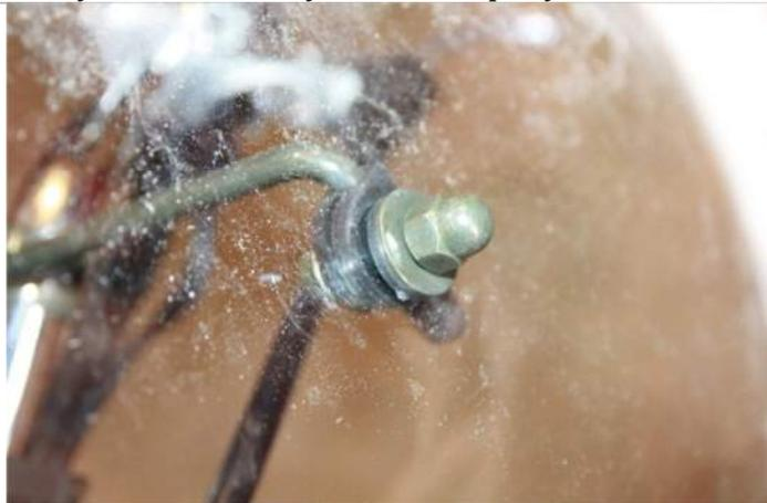
3.20.14. Прикручиваем кронштейн крепления лобового стекла к лобовому стеклу через ранее установленные прокладки так, как указано на рисунке.
