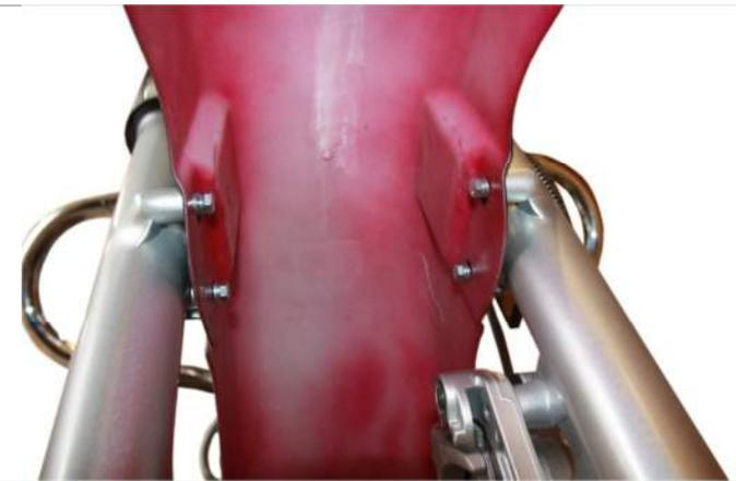
3.17.6. Зафиксируйте крыло ранее выкрученными винтами.
