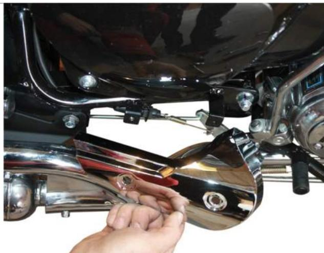
3.14.1. Откручиваем два винта крепления защитной накладки, указанные на рисунке.
