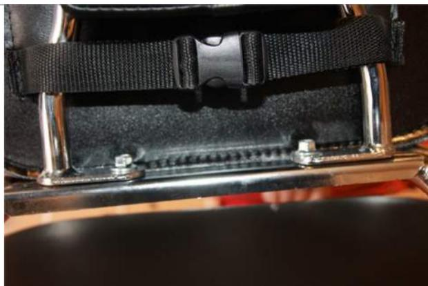
3.15.1. Устанавливаем задний кофр. Он крепится с помощью ремней, фиксирующихся с помощью пластиковых защелок, на спинке заднего пассажира....
