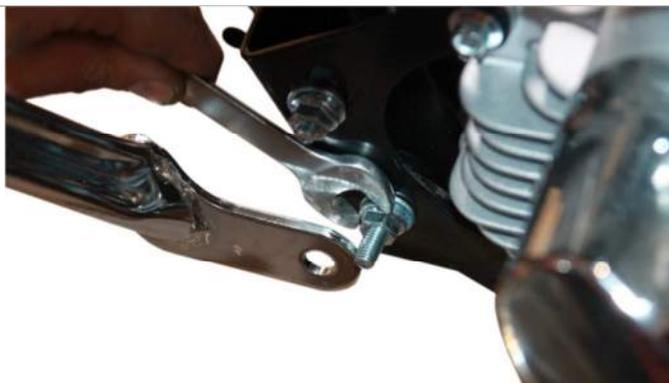
3.16.4. Для крепления хомута в нижней части откручиваем указанную на рисунке гайку.
